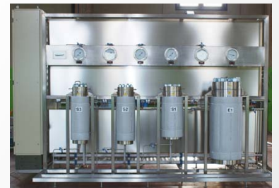
Impianto di estrazione SFE (Supercritical fluids extraction) Condizioni di estrazione adottate: P=300 bar; T=40°C; resa= 30%; durata del processo= 7h.
